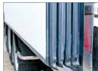
Оптимизированное четыреххромочное уплотнение дверей для обеспечения повышенной герметичности и снижения энергопотребления
