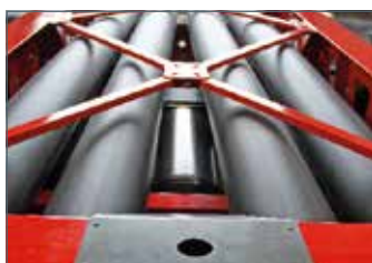
Opslag voor slangleidingen
