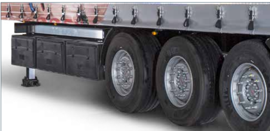
Boczne przechowywanie listew wkładanych
