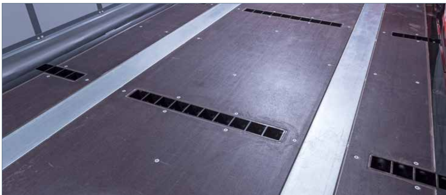
Osiem sztuk listew z kieszeniami na kłonicie: maksymalna zmienność
