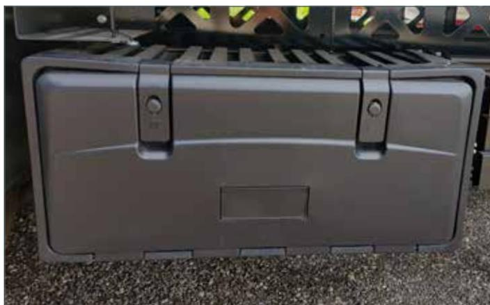
Großer Werkzeugkasten, Abmessung (innen) ca. 923 x 422 x 460 mm
