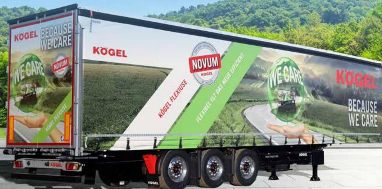
Der Kögel FlexiUse – der Name ist Programm. Zugmaschinen mit verschiedenen Sattelkupplungshöhen können dank eines speziellen Fahrwerks abgedeckt werden. Gleichzeitig kann der FlexiUse durch den höhenverstellbaren Aufbau an diese Sattelkupplungshöhen angepasst werden um die zulässigen Gesamthöhen einzuhalten. Damit löst der Trailer nicht nur noch mehr Transportaufgaben, sondern spart den Speditionen auch Zeit und Geld.
