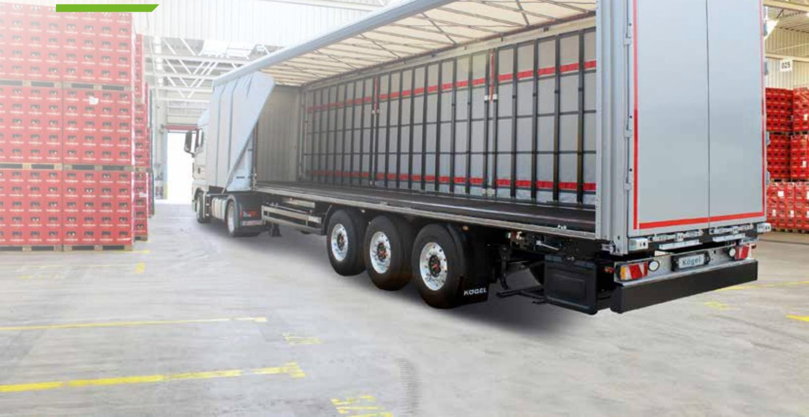
Kögel FastSlider ist ein leicht und schnell zu öffnendes und schließendes Schiebepanensystem, das Entwickelt wurde um das tägliche Leben zu vereinfachen. Beidseitig oder in Fahrtrichtung links verfügbar, lässt sich der FastSlider an zahlreiche logistische Herausforderungen wie für Automotive-, Getränke- oder Palettentransporte vielseitig anpassen.
