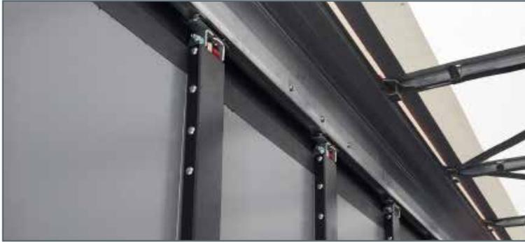
**Obere Führungsschiene ist im Dachgurt integriert**
