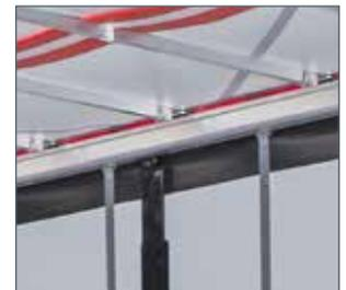
Seitliche Durchladehöhe für Beladung von der Seite erhöhen, gleichzeitig Ladeflächenbreite bis unter das Dach dank 163 mm L-Dachgurtprofil
