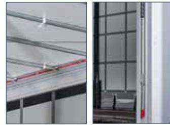
Seitliche Durchladehöhe für Beladung von der Seite erhöhen, gleichzeitig Ladeflächenbreite bis unter das Dach dank 163 mm L-Dachgurtprofil
