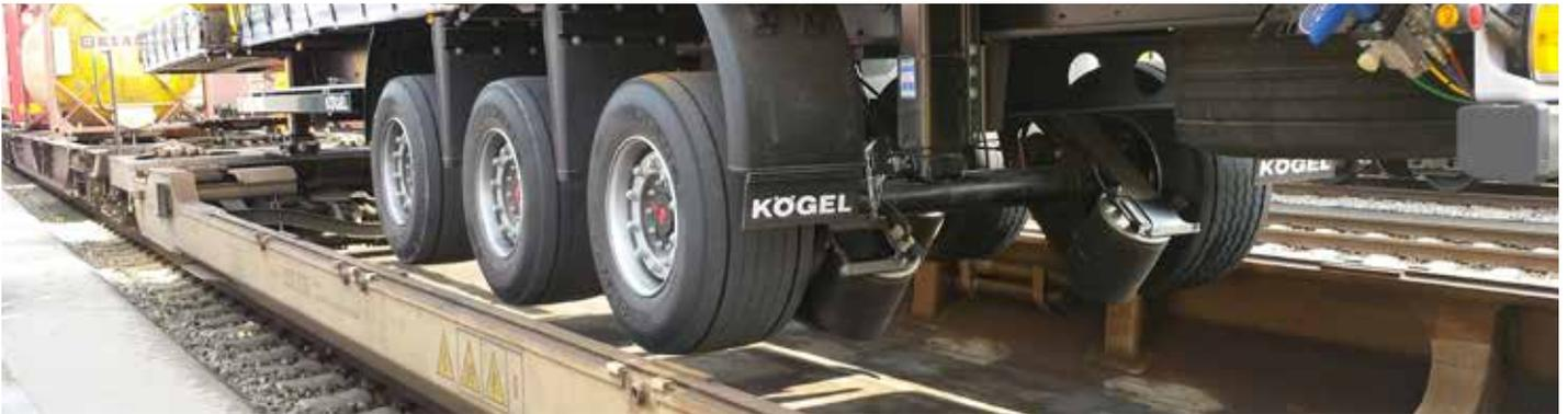
Die Bahncodifizierungszahl der Fahrzeuge ist direkt von der Gesamthöhe der Fahrzeug im Taschenwagen abhängig. Die Bahncodifizierungszahl gibt vor, auf welchen Bahnstrecken ein Fahrzeug eingesetzt werden kann.
