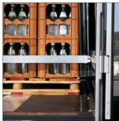
**Teilladungssicherung mit Wendelatte:** Die Wendelatten können mit der seitlichen Ladungssicherungsschiene kombiniert werden.
