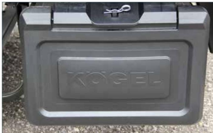
Kleiner Werkzeugkasten, Abmessung (innen) ca. 545 x 400 x 400 mm
