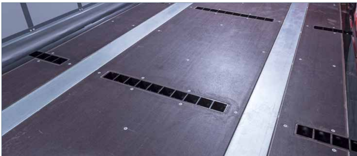
Osm kusů lišt s kapsami na sloupky: maximální variabilita
