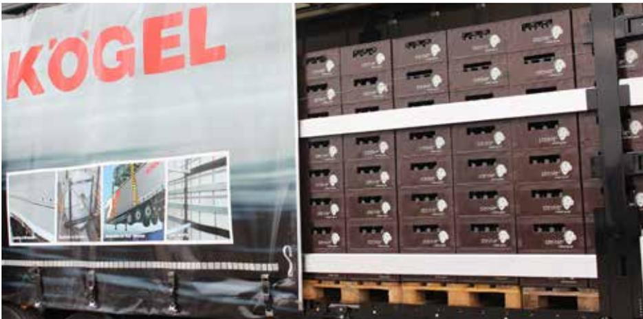
Transporte de bebidas en una capa con dos hileras de tablas de remonta apilables. Transporte de bebidas en dos capas con tres hileras de tablas de remonta apilables
