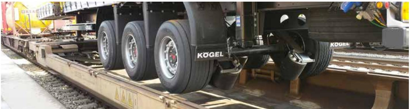
El número de codificación ferroviaria de los vehículos depende directamente de la altura total del vehículo en el vagón canguro. El número de codificación ferroviaria específica en qué tramos de vía puede utilizarse un vehículo.
