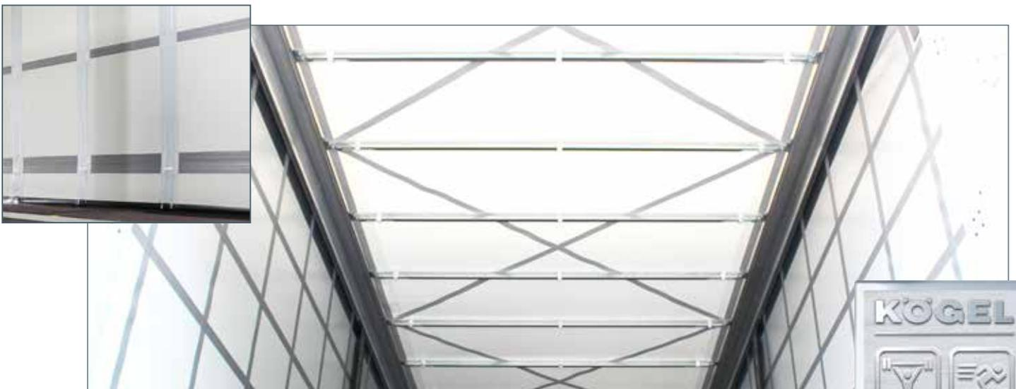
El transporte de bebidas en una y dos capas sin tablas de remonta apilables es posible gracias al sistema de retención integrado en la lona.
