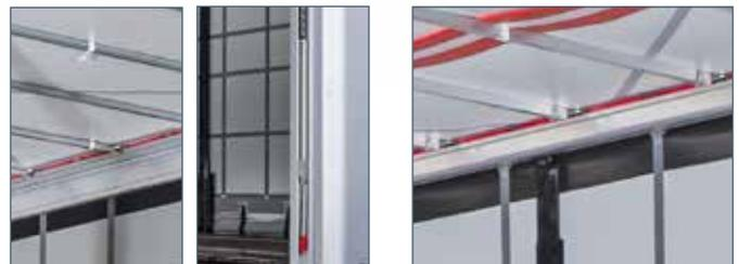
Aumento de la altura de carga corrida para la carga lateral, al mismo tiempo, anchura de la superficie de carga hasta debajo del techo gracias al perfil de correas de techo en L de 163 mm
