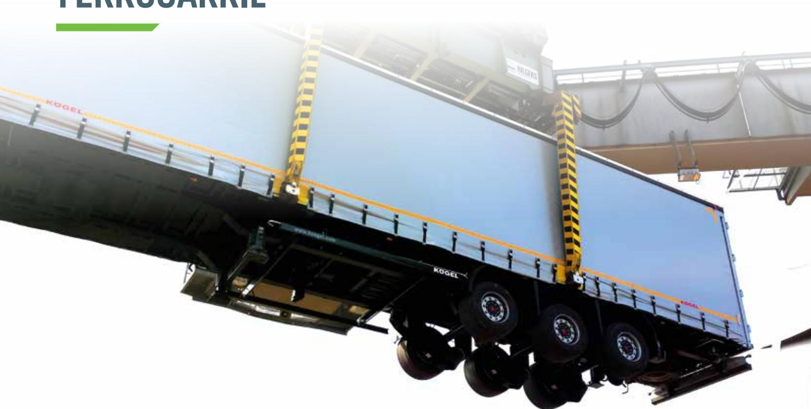
La versión Rail para semirremolques significa en pocas palabras: un semirremolque se carga en un vagón de ferrocarril con una grúa. El vehículo debe estar especialmente equipado para este fin:
