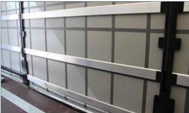
Dos hileras de tablas de remonta apilables
