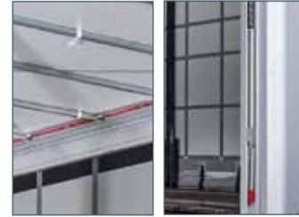
Aumento de la altura de carga corrida para la carga lateral, al mismo tiempo, anchura de la superficie de carga hasta debajo del techo gracias al perfil de correas de techo en L de 163 mm
