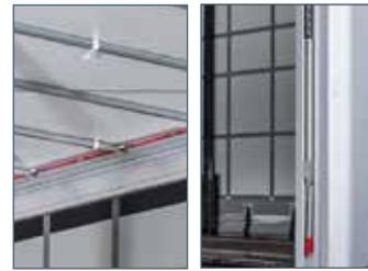
Per aumentare l'altezza di carico laterale e contemporaneamente la larghezza di superficie del carico fino a sotto il tetto grazie al profilo della cinghia del tetto a L di 163 mm
