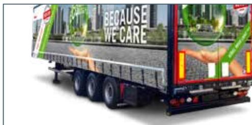
Per tutti coloro che tengono al peso proprio ridotto, ad un maggiore carico utile e ad un'altezza interna di 3 m per un'elevata stabilità, Kögel propone il Kögel Mega Light.
