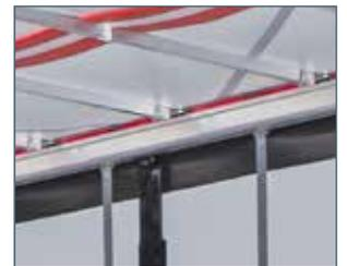
Per aumentare l'altezza di carico laterale e contemporaneamente la larghezza di superficie del carico fino a sotto il tetto grazie al profilo della cinghia del tetto a L di 163 mm
