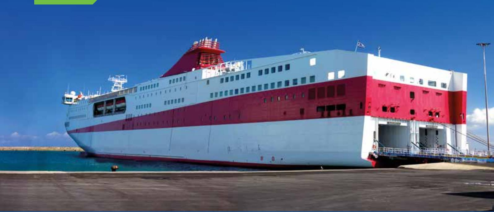
O tráfego RoRo (Roll-on/Roll-off) descreve a utilização de veículos em ferries. Os semirreboques são fixados nos ferries tal como se de uma carga se tratasse.
