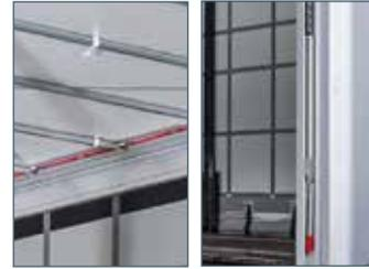
Aumentar a altura de carga lateral para o carregamento pela lateral e, simultaneamente, a largura da área de carga até ao tejadilho graças ao perfil para cinta de tejadilho em L de 163 mm
