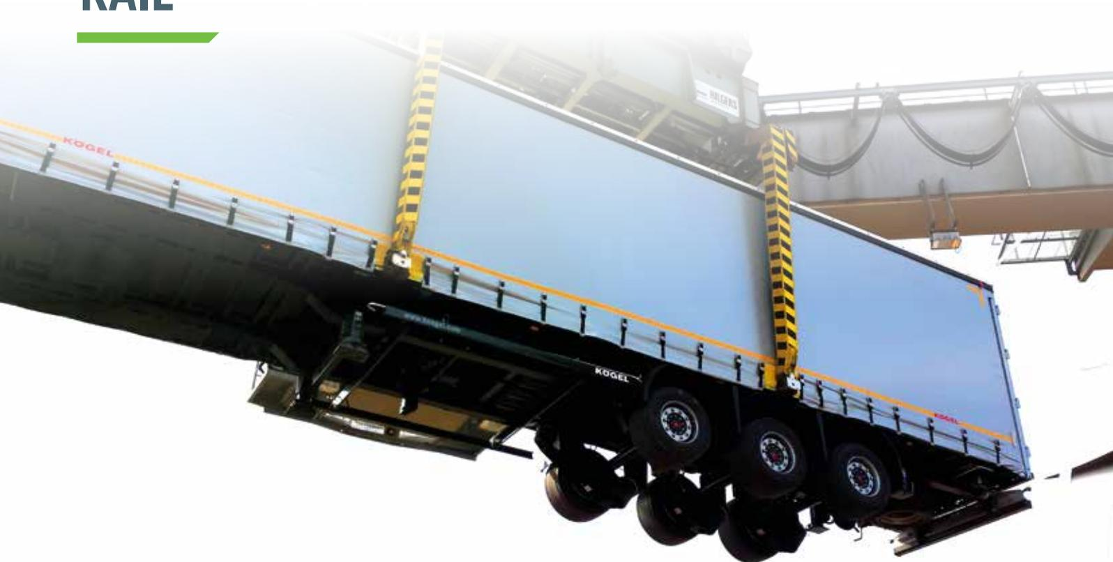
Em termos simples, o conceito Rail para semirreboques significa: um semirreboque é carregado para um vagão ferroviário com uma grua. Para o efeito, o veículo tem de possuir um equipamento especial:
