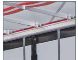
Aumentar a altura de carga lateral para o carregamento pela lateral e, simultaneamente, a largura da área de carga até ao tejadilho graças ao perfil para cinta de tejadilho em L de 163 mm
