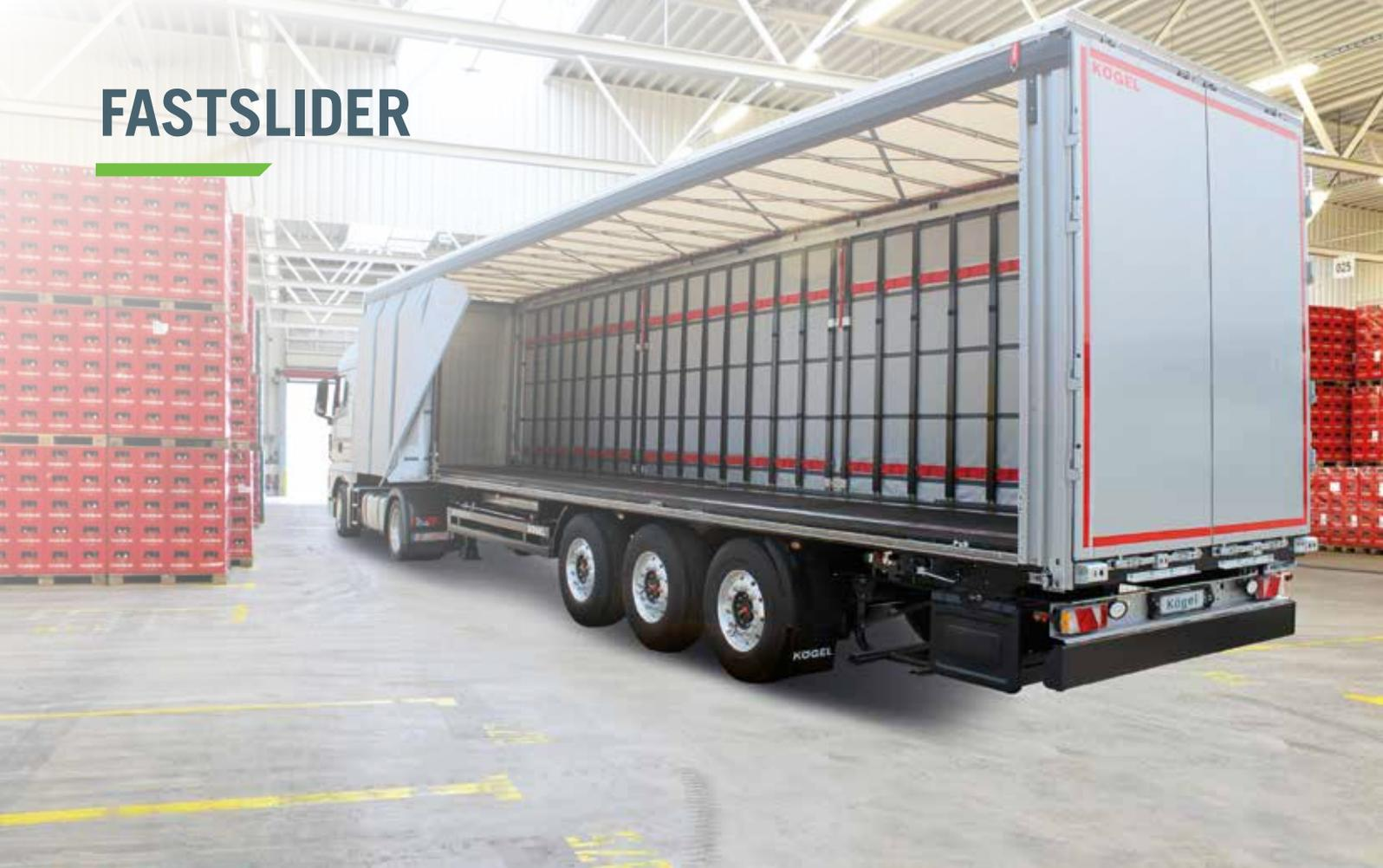
O Kögel FastSlider é um sistema de lona deslizante leve, fácil e rápido de abrir e fechar que foi desenvolvido para simplificar a vida quotidiana. Disponível em ambos os lados ou à esquerda na direção da marcha, o FastSlider pode ser adaptado para responder a uma vasta gama de desafios logísticos, tais como o transporte automóvel, de bebidas ou de paletes.
