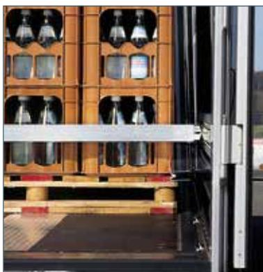
**Fixação de carga parcial com barra de inversão:** As barras de inversão podem ser combinadas com as barras laterais de fixação da carga.
