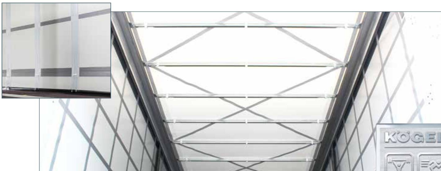
Possibilidade de transporte de bebidas de um e dois níveis sem barras de encaixe graças ao sistema de retenção integrado na lona.
