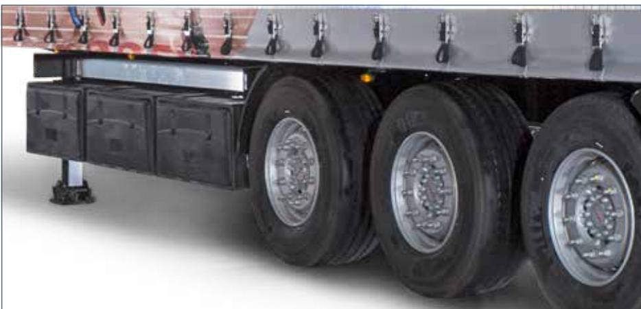
Armazenamento lateral de barras de encaixe
