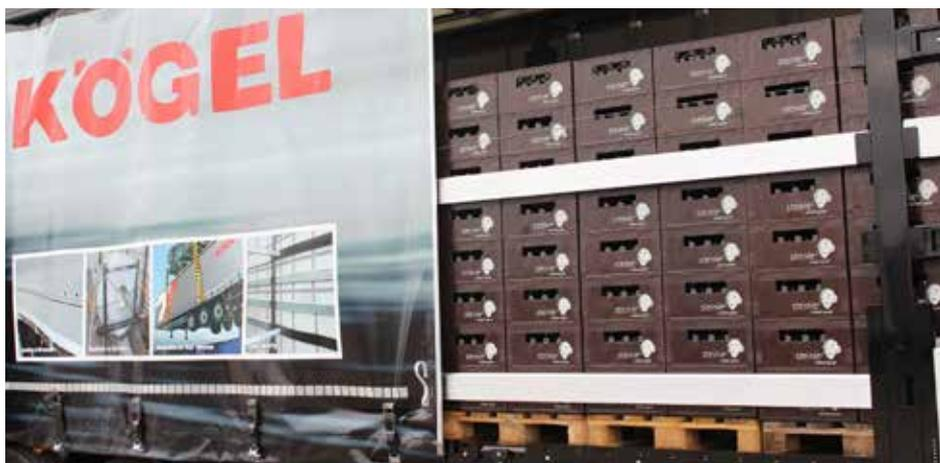
Transporte de bebidas de um nível com duas filas de barras de encaixe
