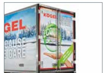
Edelstahlportal mit Drehstangen und einfach austauschbaren Scharnieren
