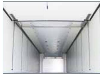
85 Millimeter starkes Sandwichelement mit Isolationskern
