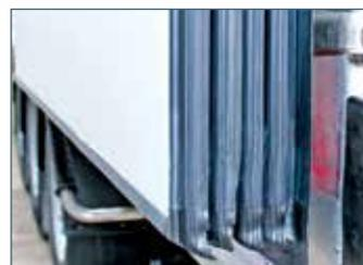
Cuádruple junta de puerta de tipo labio optimizada para proporcionar una alta estanqueidad y un menor consumo de energía
