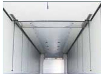
Elemento sándwich de 85 mm de grosor con núcleo aislante
