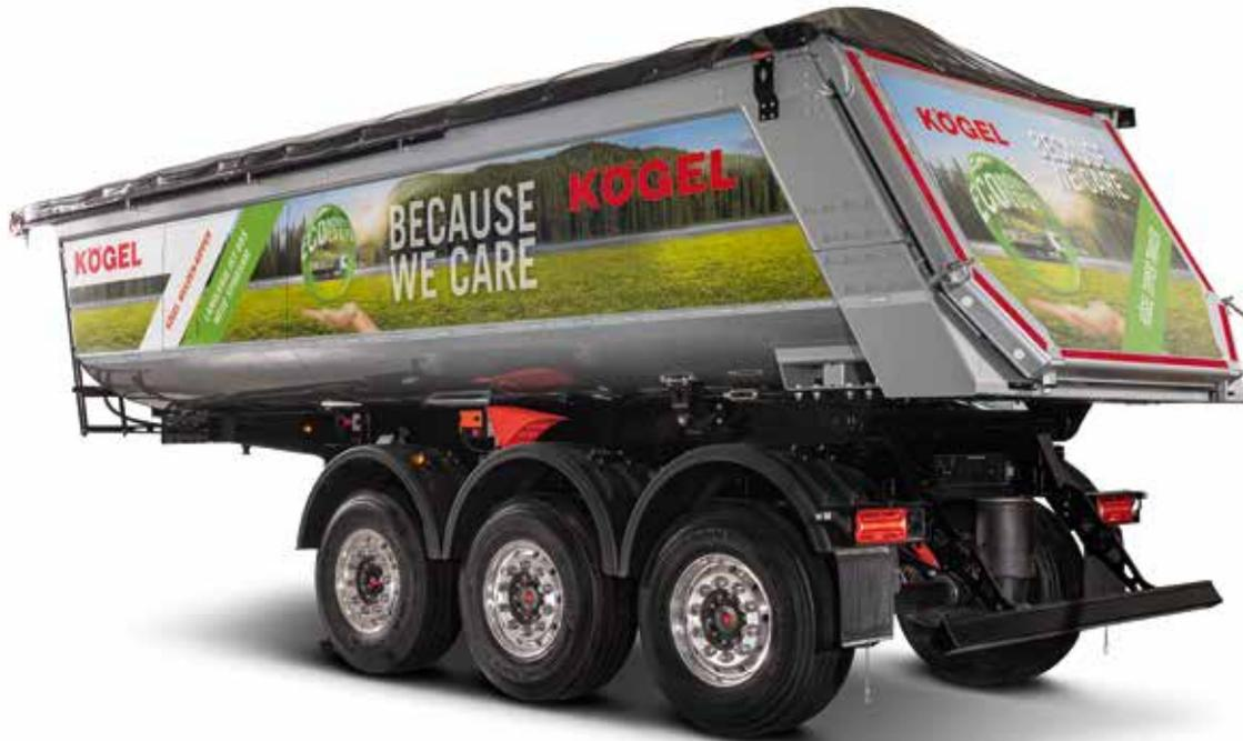
Die zwei- und dreiachsigen Kögel Mulden-Kipper mit 24 m<sup>3</sup> Ladevolumen sind in allen verfügbaren Wand- und Muldenstärkenvarianten auch mit einer vollisolierten Thermomulde erhältlich. Natürlich verfügt auch der Kögel Asphalt-Mulden-Kipper über den um 170 mm verlängerten Überhang der Mulde, den Kögel bereits 2014 vorgestellt hat. Damit eignet sich der Asphalt-Kippmulden-Sattelanhänger perfekt für den Straßenfertigungsinsatz. Eine optional angebrachte Schütte ist somit nicht nötig.
