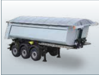
Cobertura elétrica da caixa basculante (opcional)
