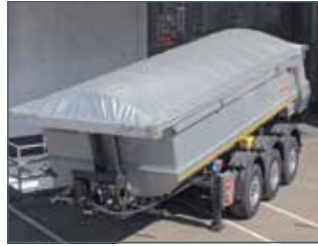
Cobertura elétrica da caixa basculante (opcional)
